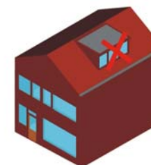
bij flauwe kaphelling (<math><30^\circ</math>) geen dakkapel doordat bovenzijde dakkapel gelijk loopt met nok, waardoor silhouet van het gebouw wordt aangetast
