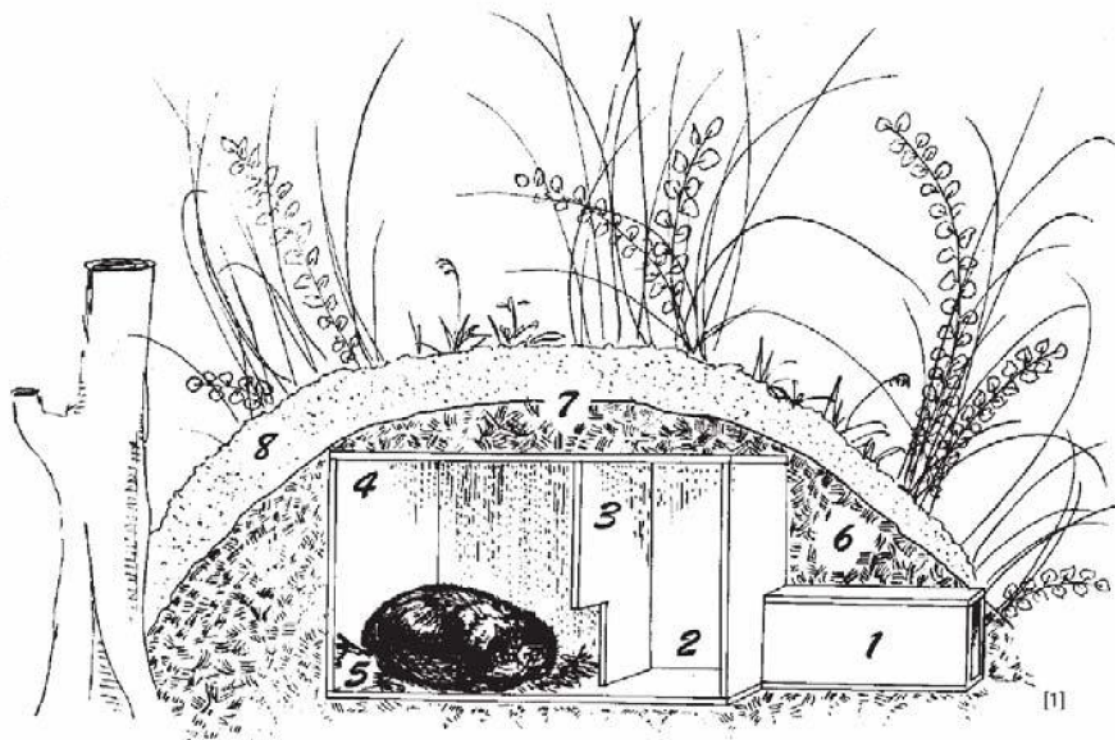
Voorbeeld van een gecompartmenteerd marterhuis overdekt met aarde en beplanting. (bron: Altröck et al)
